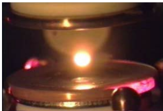
図 1 地上静電浮遊炉での浮遊と加熱
